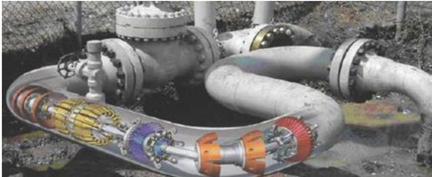
Slika 2. Inteligentni čistač (Intelligent pigging) - kracer
