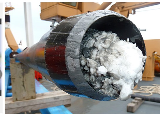
Slika 2. Način formiranja i izgled hidrata u gasovodima [3,
